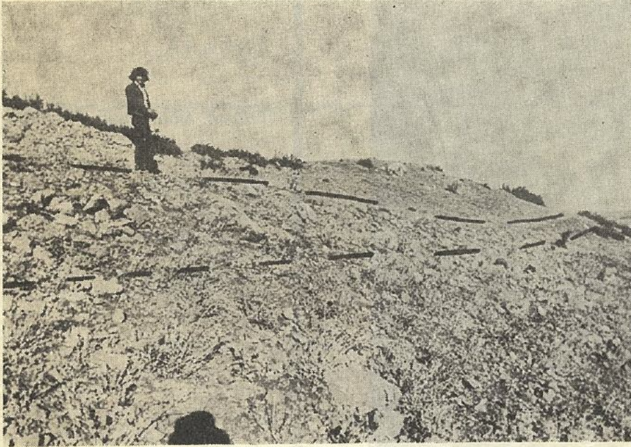
Şekil 14: Dernek'in kuzeydoğusunda yamaçta meydana gelen kabarma. Ortalama 60 cm kabarmanın meydana geldiği zon çizgiler arasına alınmıştır.
